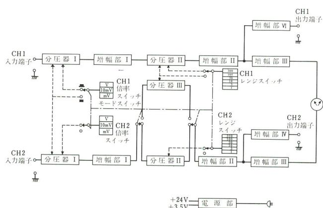
**分圧器 I** 0dB、20dB、60dBのATTで構成されています。
