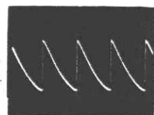
⑤ 垂直偏向出力(電流波形)
