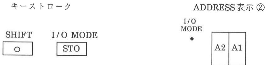
A1, A2 は, GP-IB のデバイスアドレスを 0~30 の 10 進数で表示します。
