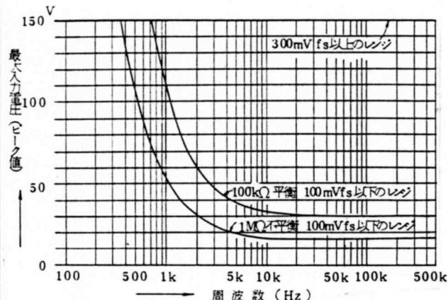
2-1図 100 kΩ平衡と1 MΩ不平衡の入力耐圧
