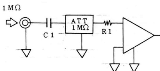
4-7 図  $1\text{ M}\Omega$  不平衡入力回路
