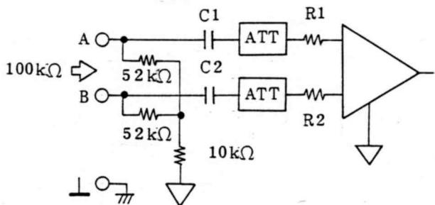
4-5図 100kΩ平衡入力回路
