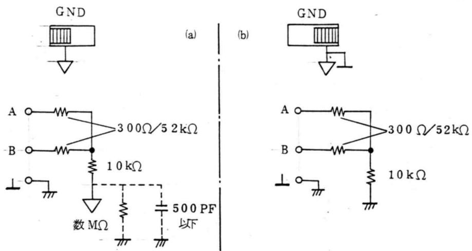
図 4-8 GNDスイッチの効果(平衡入力)
