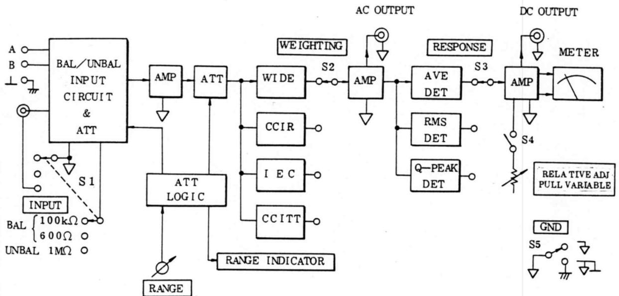
1 - 3 図 VP-9680A の簡略系統図
