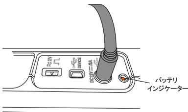
4. インターフェイスパネルの電源スイッチを ON のポジションにします。
