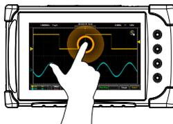
表示にタッチしてしばらくしてから指を離します。操作は指を離れたときに認識されサブメニューが表示されます。
