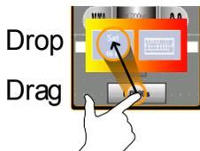
キーにタッチしたまま指を動かし、表示される設定アイコンの上で離します。水平・垂直・トリガポジションの数値設定で、0設定または数値入力ができます。
