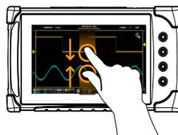
2本指で画面にタッチし、指の間隔を狭めると表示・設定がズームアウトします。
