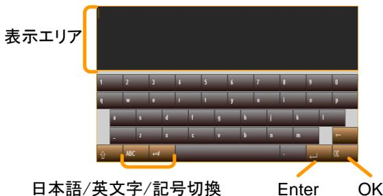
キーを押すと表示エリアに文字が追加されます。記号入力は”+=#”を表示押します。英文字入力は”ABC”を表示させて入力し、大文字は↑を押します。日本語入力は”あいう”を表示させ、入力モードを”平”, ”片”, ”漢”から選び、入力します。漢字は読みを入力後一覧が表示されますので選択します。Enter で改行し、OK で入力が終了します。
