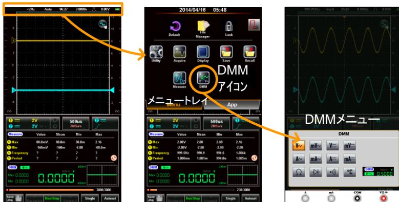
2つ目の方法は DMM の測定結果の表示エリアを長押しして、DMM メニューを表示します。
